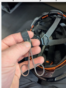
2. rozpárejte nebo rozstříhnete původní popruh | rip or cut the original strap
